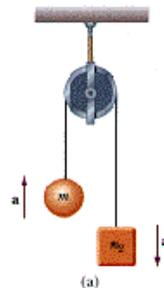
Determine (a) la tensión en la cuerda, (b) la aceleración de cada masa, y (c) la distancia que avanza cada masa en el primer segundo de movimiento si parten del reposo.
