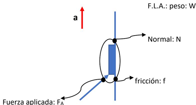
Como podemos observar en el modelo pictórico encontramos tres intersecciones correspondientes a las interacciones de contacto que identificamos como fuerza aplicada, fricción y normal, mientras que para la interacción de largo alcance tenemos, como sucede en general, el peso. Tenemos identificado también la situación de movimiento que corresponde a una aceleración del libro hacia arriba de la superficie.
