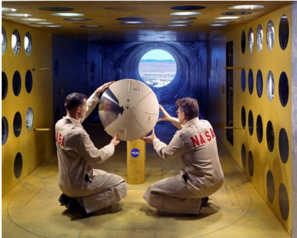
El vehículo FIRE, ensayado en un túnel de viento. (Foto: NASA)
