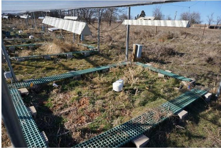
La imagen muestra las parcelas que fueron calentadas para simular el calentamiento climático previsto por los modelos. Los radiadores, en la parte superior, calentaban las parcelas de suelo hasta 2 grados centígrados por encima de la temperatura natural. (Foto: Mengting Yuan, Universidad de Oklahoma)
