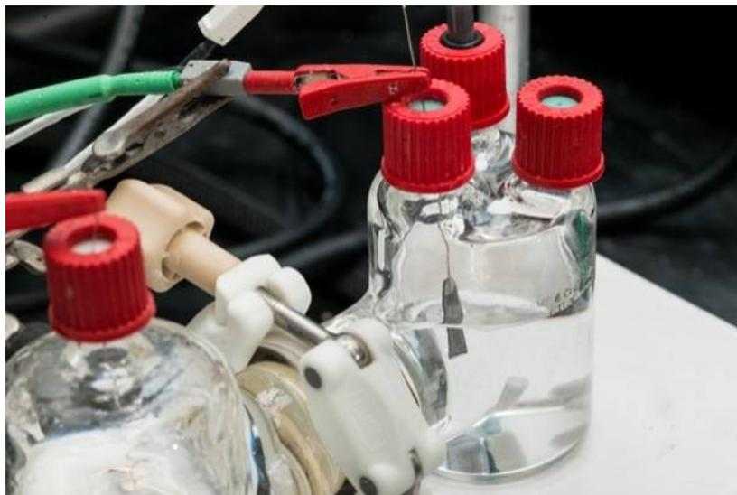
El equipo de Feng Jiao ha desarrollado un catalizador muy selectivo capaz de convertir, mediante un proceso electroquímico, el dióxido de carbono en monóxido de carbono, con una eficiencia del 92 por ciento. (Foto: Evan Krape)
