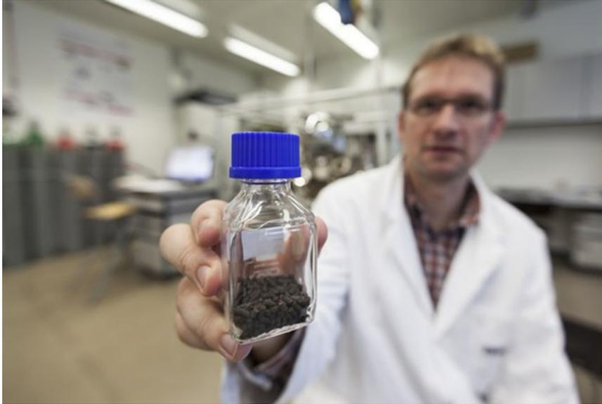
Las zeolitas absorben moléculas de agua producidas durante la metanación de hidrógeno, por lo que mejoran la producción de metano en el nuevo proceso. (Foto: EMPA)
