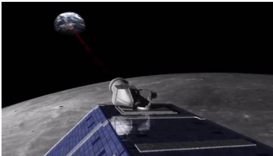
La LADEE usó un láser para comunicar con la Tierra. (Foto: NASA)
