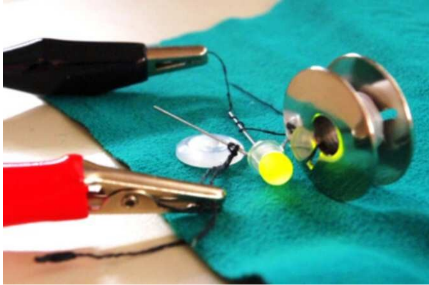
Transistor electroquímico hecho con fibras de algodón. (Foto: Cornell U.)
