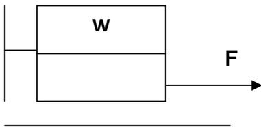
El bloque superior es sujeto a la pared por una cuerda. El bloque inferior es jalado por una fuerza  $F$ . El coeficiente de fricción estático entre todas las superficies en contacto es  $\mu$ . ¿Cuál será la fuerza más grande que se pueda aplicar antes de que el bloque inferior comience a resbalar?
