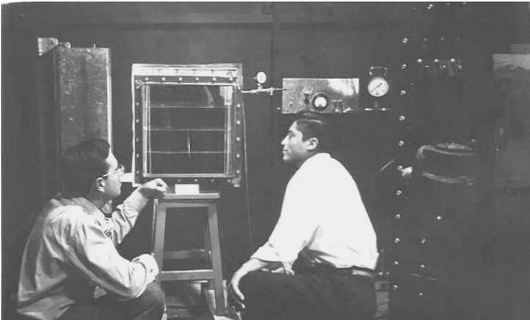
Sistema de cámara de Wilson y control electrónico en Laboratorio de Radiación Cósmica, Instituto de Física UASLP.
