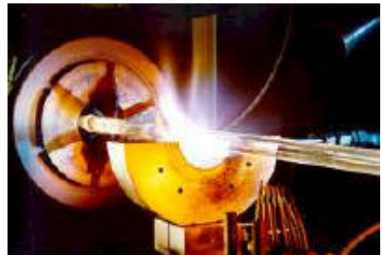
Foto cortesía de: Fibercore Ltd. Soporte usado en la preparación de la preforma.
