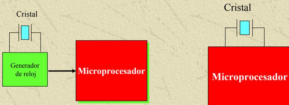
Los primeros microprocesadores requerían un dispositivo generador de reloj externo, no contenían la lógica interna necesaria para generarlo (como el Z80)
