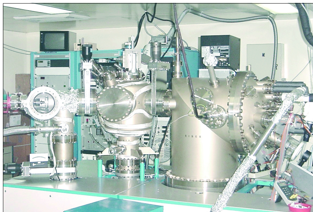
Sistema de deposición por haces moleculares en donde se realiza el crecimiento de los dispositivos.
